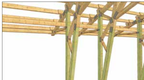
Sammensatte takstolrammer for økt spenn, og lengre cc-avstand
